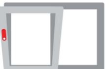
Pozitie batantă a cercevelei pentru ventilație
