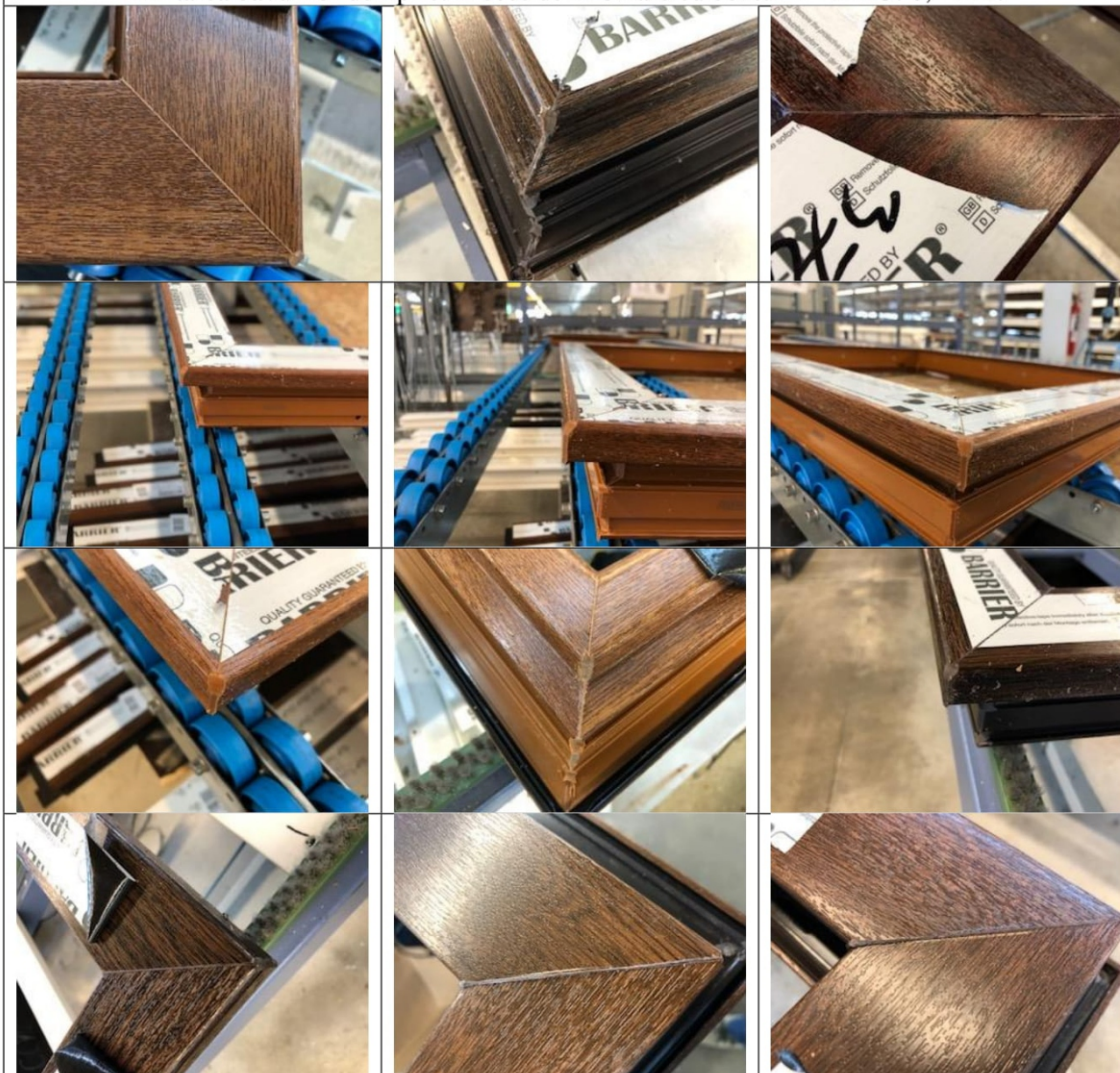
Limitarea bavurilor de lipire: Proces de îmbinare cu contur REHAU: 0,2 mm.
