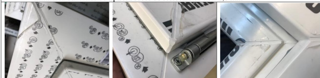
Limitarea bavurilor de lipire: Proces de forfecare cu nut: 2,0 mm
